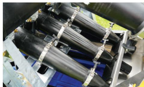
**SEPARAZIONE EFFICIENTE.** Elevate prestazioni nella separazione dei solidi grazie a 6 idrocicloni a corpo lungo da 4 pollici in abbinamento ad un'area di vagliatura piuttosto ampia.
