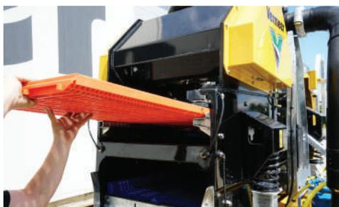
**SOSTITUZIONE RAPIDA DEI VAGLI.** I vagli primari sono mantenuti in posizione da un sistema di ancoraggio ad aria, azionato da un compressore di bordo. Ciò permette un accesso semplificato e la sostituzione rapida dei vagli.
