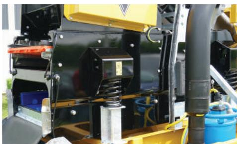
**PERFORMANCE COSTANTE.** Il robusto vibrovaglio garantisce performance stabili anche con volumi di processo variabili. Una pompa ad elevata capacità di processo da 15 hp (11 kW) è utilizzata per garantire una circolazione ottimale.
