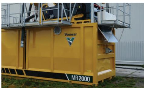
**TRASPORTO INTELLIGENTE, CANTIERE LINEARE.** Per ridurre le dimensioni di trasporto, il modulo di separazione con vibrovaglio viene alloggiato nella vasca attiva. Grazie ad un sistema di sollevamento idraulico automatico, il modulo può essere montato facilmente, sopra al container, pronto per entrare in azione. L'architettura lineare di questo sistema, con una parete cieca, lo rende ideale per cantieri a bordo strada.
