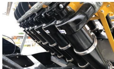
**SEPARAZIONE OTTIMALE.** Elevate prestazioni nella separazione dei solidi grazie a due idrocicloni desander da 10 pollici, più 12 idrocicloni a corpo lungo da 4 pollici in abbinamento a un'ampia area di vagliatura.
