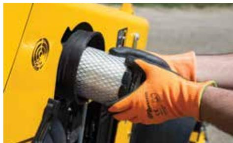
**MANUTENZIONE.** L'accesso ai punti di manutenzione richiesti, nonché ai filtri del carburante, dell'olio idraulico, dell'olio motore e dell'aria, non richiede la rimozione di un coperchio, il che può aumentare l'efficienza della macchina e semplificare la manutenzione quotidiana.
